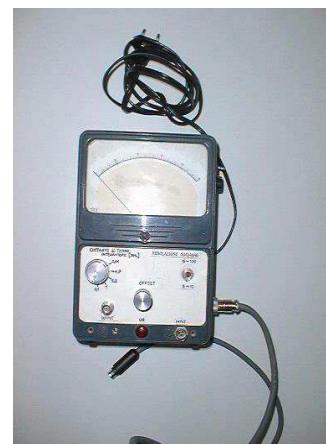
Fig. 2: Schema dell’alimentatore da rete. A destra si vede un prototipo dello strumento. L’apparecchio è stato costruito recuperando il contenitore (completo di strumento a bobina mobile) di un voltmetro elettronico da laboratorio fuori uso: si nota il pannello frontale con i comandi di regolazione del guadagno, dell’offset del segnale di uscita e della costante di tempo dell’integratore. Sono visibili i connettori BNC per il segnale di ingresso e di uscita, il cavo per la connessione seriale del PC.
