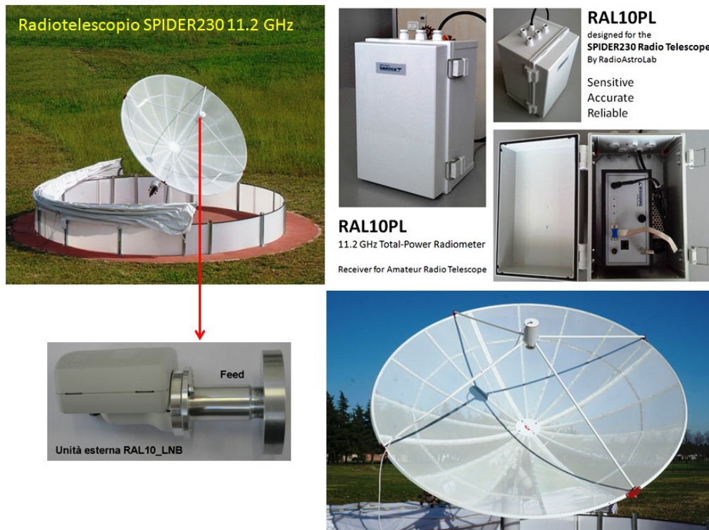
Fig. 1: Il radiotelescopio SPIDER230 utilizzato per la registrazione del transito di Taurus A (nebulosa M1).
