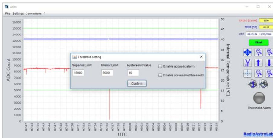
Figura 4.21. Impostazione dei livelli di soglia e dell'isteresi per l'allarme di acquisizione.
