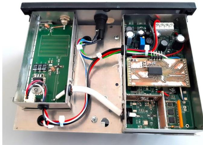
**Fig. 15:** Particolare interno del radiometro: all'interno della scatola metallica schermata (è stato rimosso il coperchio) si vede il circuito del modulo radiometrico che gestisce il funzionamento dello strumento.
