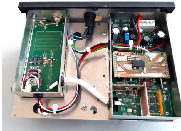
Fig. 14: Particolare interno del radiometro: all'interno della scatola metallica schermata (è stato rimosso il coperchio) si vede il circuito del modulo radiometrico che gestisce il funzionamento dello strumento.
