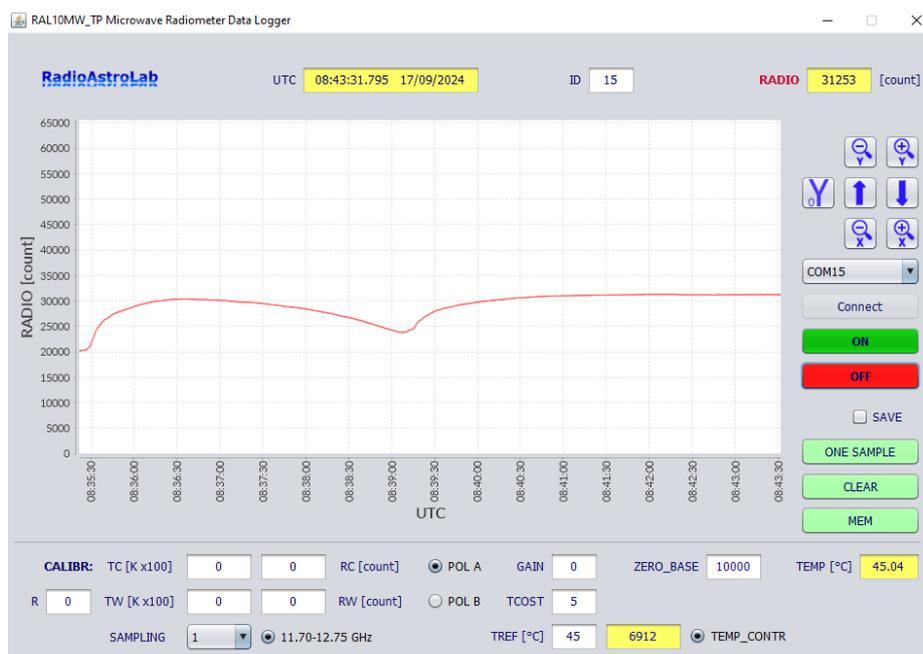
**Fig. 18:** Software *RALIOMW\_DataLogger* utilizzato per l'acquisizione delle misure e per il controllo del radiometro.
