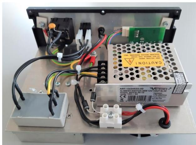
**Fig. 15:** Sezione di alimentazione da rete (230 Vac – 50/60 Hz) del radiometro. E' disponibile un ingresso a bassa tensione (12 Vdc) che consente di alimentare lo strumento tramite batterie esterne per utilizzi "sul campo".
