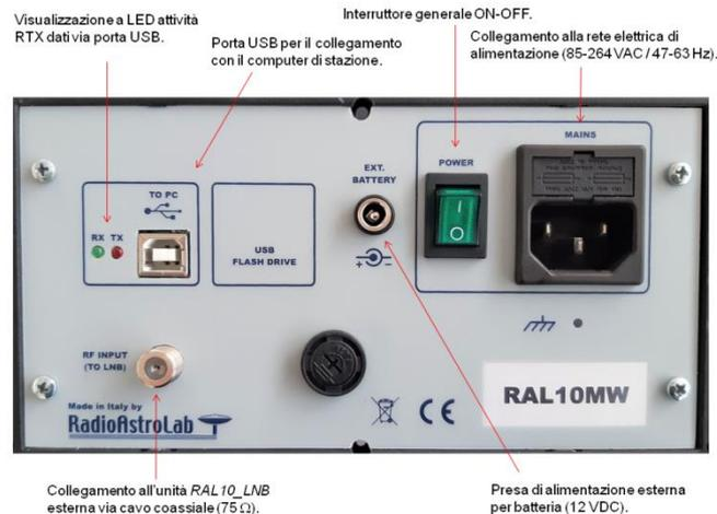
**Fig. 1:** Pannello frontale e posteriore del radiometro *RAL10MW*.
