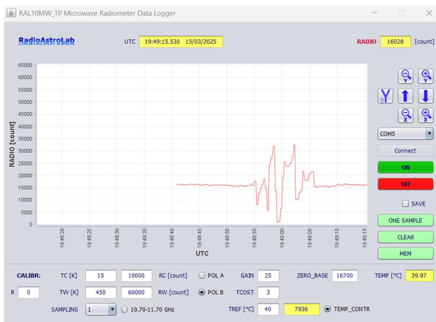
**Fig. 18:** Software *RAL10MW\_DataLogger* utilizzato per l'acquisizione delle misure e per il controllo del radiometro.
