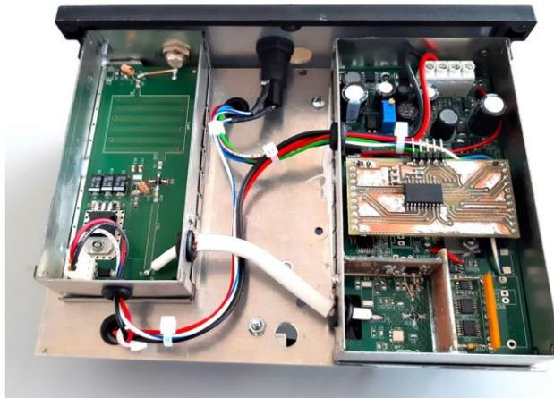
**Fig. 14:** Particolare interno del radiometro: all'interno della scatola metallica schermata (è stato rimosso il coperchio) si vede il circuito del modulo radiometrico che gestisce il funzionamento dello strumento.
