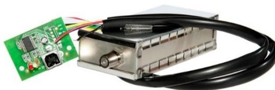
**Fig. 1:** Modulo radiometrico *RAL10KIT*.
