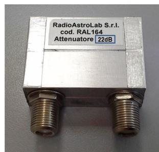
**Fig. 7:** Attenuatore da 22 dB *RAL164*.
