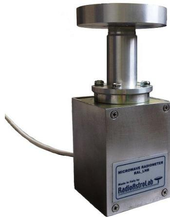
**Fig. 6:** Unità esterna *RAL10\_LNB* completa di illuminatore *RAL10\_FEED* per antenna parabolica circolare. Il gruppo deve essere installato sul punto focale di un'antenna "prime focus" con un rapporto F/D compreso fra 0.32 e 0.43. Le unità *RAL10\_LNB* e *RAL10\_FEED* hanno una flangia in guida d'onda circolare tipo C-120.
