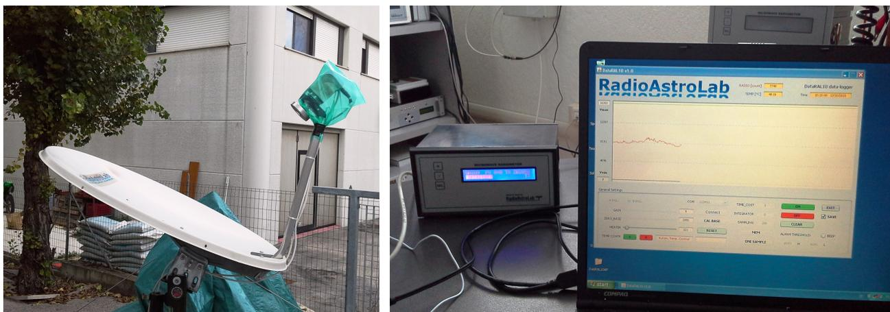
**Fig. 2:** Il radiotelescopio utilizzato nell'esperimento: si vedono l'antenna (una comune parabola offset per TV-SAT 10-12 GHz da 70 cm) equipaggiata con l'unità esterna RAL10\_LNB e il ricevitore RAL10.
