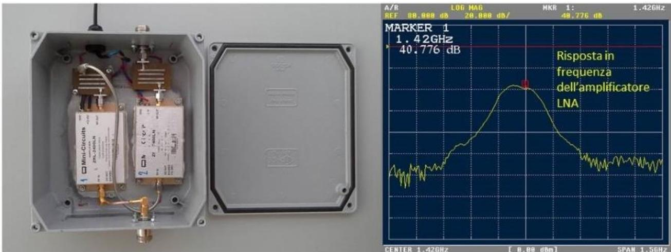
Amplificatore (LNA) inserito fra l'antenna e il ricevitore. Il dispositivo è stato costruito collegando in cascata un filtro passa-banda centrato su 1420 MHz, due amplificatori commerciali a larga banda (basso rumore ed elevata dinamica), ulteriore filtro passa-banda, identico al precedente, collegato all'uscita. L'immagine mostra la risposta in frequenza dell'amplificatore.
