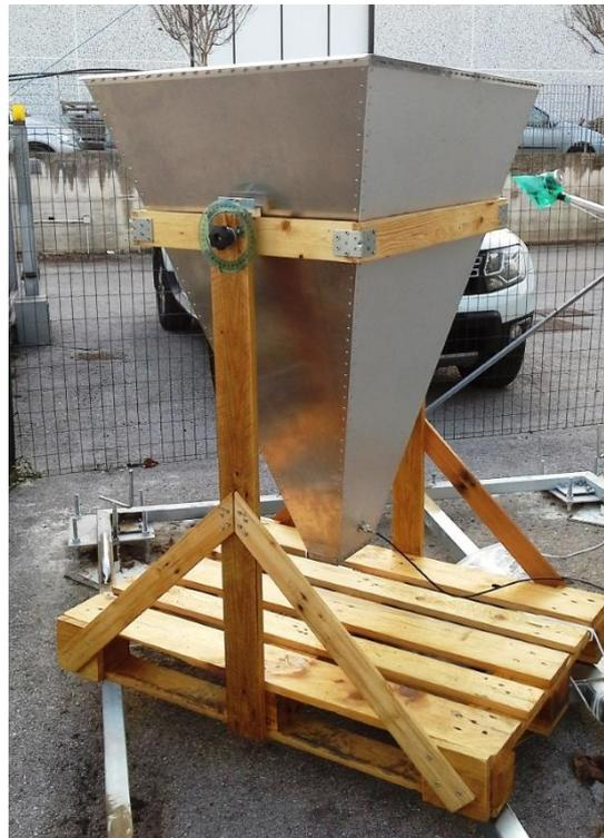
Questo è il prototipo dell'antenna da noi costruita per studiare il cielo alla frequenza 1420 MHz dell'idrogeno neutro. Si tratta di una tipica realizzazione amatoriale: l'antenna è realizzata con fogli di alluminio e installata su un supporto di legno orientabile manualmente in elevazione (orientamento
