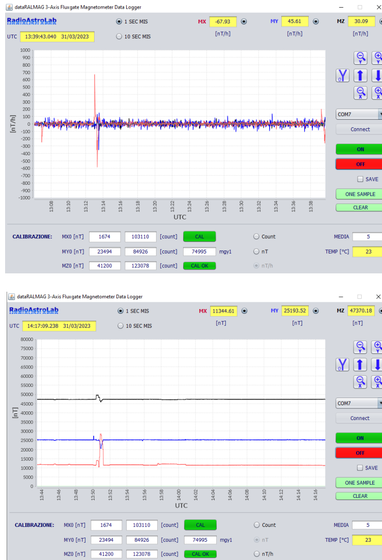
Fig. 7: Programma dataRALMAG sviluppato per il controllo dello strumento e per l'acquisizione delle misure. Si tratta di una consolle dove sono presenti i comandi e una finestra grafica che visualizza gli andamenti nel tempo del campo magnetico associato alle tre componenti (tracce di colore rosso, blu e nero) e i suoi valori nelle unità di misura scelte (caselle di colore giallo in alto). Dopo aver abilitato la connessione seriale fra lo strumento e il PC (menù con lista per la scelta della porta virtuale COM fra quelle disponibili e conferma tramite il pulsante Connect ), quando è attivata l'acquisizione continua dei dati (pulsanti ON-OFF) le tracce si muovono come un registratore grafico da destra verso sinistra, al ritmo di 1 misura al secondo (quando è selezionato il pulsante 1 SEC MIS in alto) oppure 1 misura ogni 10 secondi (pulsante 10 SEC MIS ). Le scale dei grafici possono essere aggiustate tramite gli appositi comandi. La modalità di campionamento 10 secondi è ad elevata risoluzione, adatta alla cattura di pulsazioni geomagnetiche anche molto deboli causate dall'attività del Sole. Tramite i comandi Count , nT , nT/h (in basso) è possibile scegliere l'unità di misura (campo espresso in unità non calibrate [ count ] o calibrate [ nT ], oppure la misura delle variazioni del campo (in [ nT/h ]) rispetto al valore mediano, calcolato sul numero di campioni specificato nella casella MEDIA . Il programma visualizza la temperatura interna del modulo sensori (in [ ^{\circ}C ]) e salva i dati acquisiti in un file di testo, previa abilitazione del comando SAVE . In base sulla consolle sono presenti le caselle e i comandi necessari per inserire i dati di calibrazione ed attivare il solenoide che genera un incremento noto di campo magnetico sul sensore Y. La figura mostra due modalità di acquisizione e di rappresentazione dei dati: in alto è stata selezionata la misura delle variazioni del campo ( nT/h ), in basso la misura calibrata standard. I parametri di calibrazione e di media sono salvati nei file di testo (modificabili) RALMAG_log1.txt e RALMAG_log10.txt (rispettivamente per la modalità di campionamento 1 secondo o 10 secondi), residenti sulla cartella dove è presente il programma Data_RALMAG .
