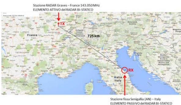
**Figura 4:** Distanza TX-RX del radar bi-statico.
