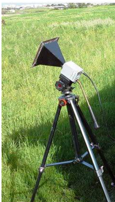
Radar per la navigazione marittima in banda X (10 GHz)
