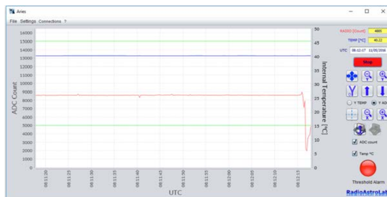
FIGURA 4.11: Spia di allarme che segnala quando la traccia radiometrica eccede il valore delle soglie impostate (righe orizzontali di colore verde sulla finestra grafica).
