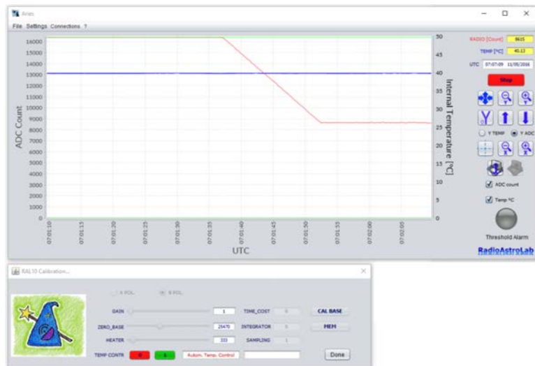
FIGURA 3.10: Il segnale radiometrico (traccia rossa) si è stabilizzato al centro della scala di acquisizione dopo la calibrazione della linea di base.
