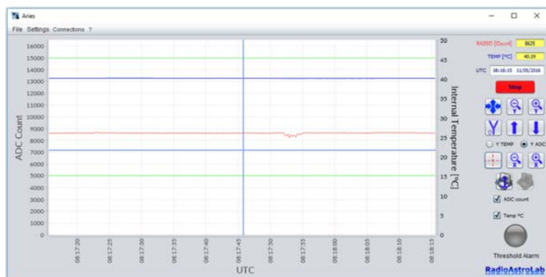
FIGURA 4.9: Funzione di Tracking attivata: evidenzia le coordinate di un punto sulla traccia grafica (pulsante con la croce tratteggiata di colore rosso).
