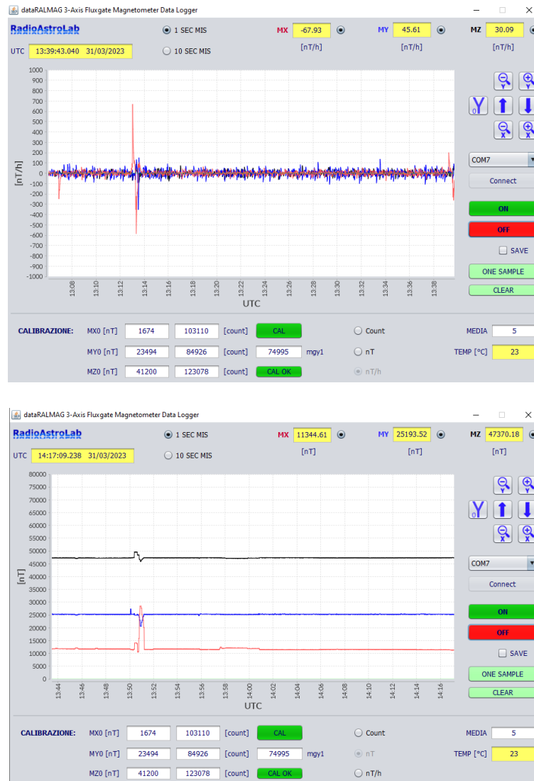
Fig. 7: Programma dataRALMAG sviluppato per il controllo dello strumento e per l'acquisizione delle misure. Si tratta di una consolle dove sono presenti i comandi e una finestra grafica che visualizza gli andamenti nel tempo del campo magnetico associato alle tre componenti (tracce di colore rosso, blu e nero) e i suoi valori nelle unità di misura scelte (caselle di colore giallo in alto). Dopo aver abilitato la connessione seriale fra lo strumento e il PC (menù con lista per la scelta della porta virtuale COM fra quelle disponibili e conferma tramite il pulsante Connect ), quando è attivata l'acquisizione continua dei dati (pulsanti ON-OFF) le tracce si muovono come un registratore grafico da destra verso sinistra, al ritmo di 1 misura al secondo (quando è selezionato il pulsante 1 SEC MIS in alto) oppure 1 misura ogni 10 secondi (pulsante 10 SEC MIS ). Le scale dei grafici possono essere aggiustate tramite gli appositi comandi. La modalità di campionamento 10 secondi è ad elevata risoluzione, adatta alla cattura di pulsazioni geomagnetiche anche molto deboli causate dall'attività del Sole. Tramite i comandi Count , nT , nT/h (in basso) è possibile scegliere l'unità di misura (campo espresso in unità non calibrate [ count ] o calibrate [ nT ], oppure la misura delle variazioni del campo (in [ nT/h ]) rispetto al valore mediano, calcolato sul numero di campioni specificato nella casella MEDIA . Il programma visualizza la temperatura interna del modulo sensori (in [ ^{\circ}\text{C} ]) e salva i dati acquisiti in un file di testo, previa abilitazione del comando SAVE . In basso sulla consolle sono presenti le caselle e i comandi necessari per inserire i dati di calibrazione ed attivare il solenoide che genera un incremento noto di campo magnetico sul sensore Y. La figura mostra due modalità di acquisizione e di rappresentazione dei dati: in alto è stata selezionata la misura delle variazioni del campo ( nT/h ), in basso la misura calibrata standard. I parametri di calibrazione e di media sono salvati nei file di testo (modificabili) RALMAG_log1.txt e RALMAG_log10.txt (rispettivamente per la modalità di campionamento 1 secondo o 10 secondi), residenti sulla cartella dove è presente il programma Data_RALMAG .
