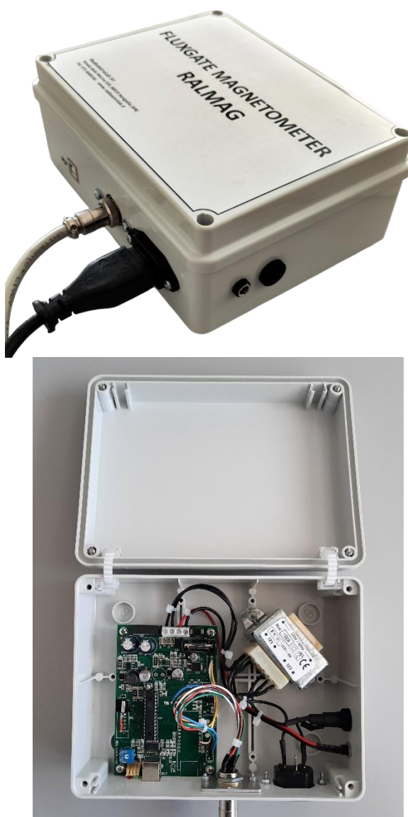
Fig. 6: Il modulo di controllo comprende un circuito elettronico a microprocessore che gestisce i segnali provenienti dai sensori fluxgate, provvede all'alimentazione generale dello strumento e alla comunicazione dei dati acquisiti tramite una porta seriale USB (che emula una porta COM) verso un computer di stazione sul quale è installato il software di gestione dataRALMAG . Lo strumento comunica con un generico host esterno attraverso un protocollo seriale proprietario (in appendice sono riportati i dettagli del protocollo). E' possibile alimentare il magnetometro attraverso una connessione alla rete elettrica monofase a 230 Vac – 50/60 Hz (cavo dedicato), oppure tramite una sorgente di alimentazione continua a bassa tensione 12-15 Vdc (ad esempio batteria esterna) attraverso l'apposto jack di alimentazione.
