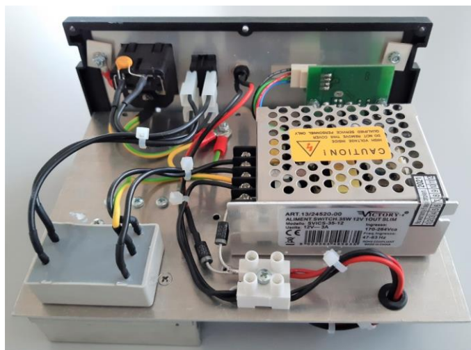
Fig. 16: Sezione di alimentazione da rete (230 Vac – 50/60 Hz) del radiometro. E' disponibile un ingresso a bassa tensione (12 Vdc) che consente di alimentare lo strumento tramite batterie esterne per utilizzi “sul campo”.
