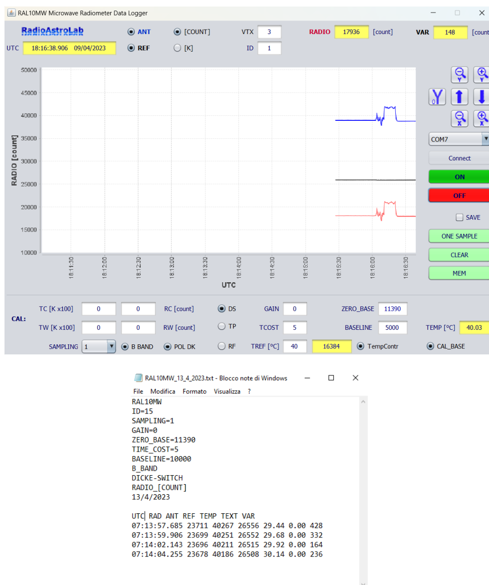
Fig. 19: Software RAL10MW_DataLogger impostato per il funzionamento del radiometro in modalità DICKE – SWITCH (radiometro a commutazione). Nella finestra grafica sono visualizzate (con differenti colori, se abilitate) le tracce che rappresentano i segnali radiometrici ANT (traccia TOTAL – POWER di colore blu quando l’ingresso del radiometro è collegato all’antenna), REF (traccia REFERENCE di colore nero quando l’ingresso del radiometro è collegato alla resistenza termicamente stabilizzata) e la risposta radiometrica RADIO = ANT - REF + BASELINE (traccia di colore rosso). Se lo strumento è impostato come radiometro a potenza totale (modalità TOTAL – POWER ), le tracce grafiche dei segnali REF e RADIO convergeranno verso il segnale ANT come una traccia unica, mentre se lo strumento è impostato in modalità REFERENCE , le tracce dei segnali ANT e RADIO convergeranno verso il segnale REF .
