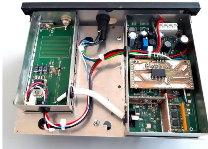
Fig. 15: Particolari interni dei circuiti del radiometro all'interno delle scatole metalliche schermate (sono stati rimossi i coperchi): a sinistra si vede l'amplificatore di ingresso a larga banda che accetta e amplifica i segnali provenienti dall'unità esterna (LNB), a destra il modulo radiometrico che gestisce il funzionamento dello strumento (in primo piano è visibile il microprocessore).
