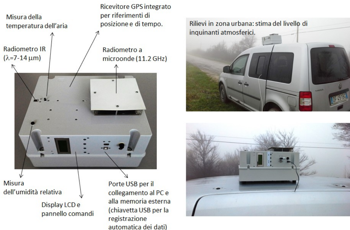
Fig. 1: Prototipo del radiometro MW (11.2 GHz) e IR ( \lambda=7-14 \mu\text{m} ) sviluppato per lo studio delle caratteristiche della troposfera. Lo strumento è posizionato sul tetto di un'autovettura con le antenne orientate sullo zenith locale. Sono misurate la temperatura dell'aria, l'umidità relativa, l'intensità del segnale radio a 11.2 GHz e l'intensità del segnale IR. Un ricevitore GPS integrato fornisce i riferimenti di posizione e di tempo ed è possibile registrare i dati tramite collegamento al PC (porta USB), oppure salvando le misure in formato testo su una comune chiavetta USB di memoria esterna, ad intervalli di tempo programmabili.
